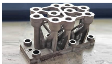
شکل ۴: یک قطعه پتروشیمی پرینت گرفته شده توسط پرینتر سه بعدی شرکت بریتانیایی GKN
